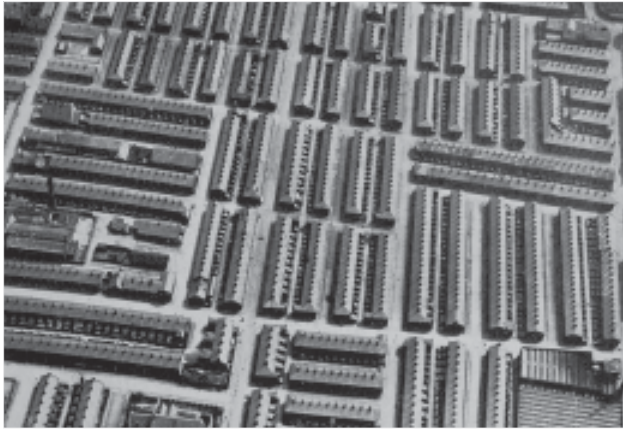
Bild 2. Lancashire Cotton Town. Utvecklingen under 1800-talet av arbetarbo- städer i England som resultat av det så kallade "bye-laws". Modellen bygger på upprepning av samma husmodul i radhuslängor som täcker stora områden i närheten av industrier. Källa W. Hegemann 1938.
