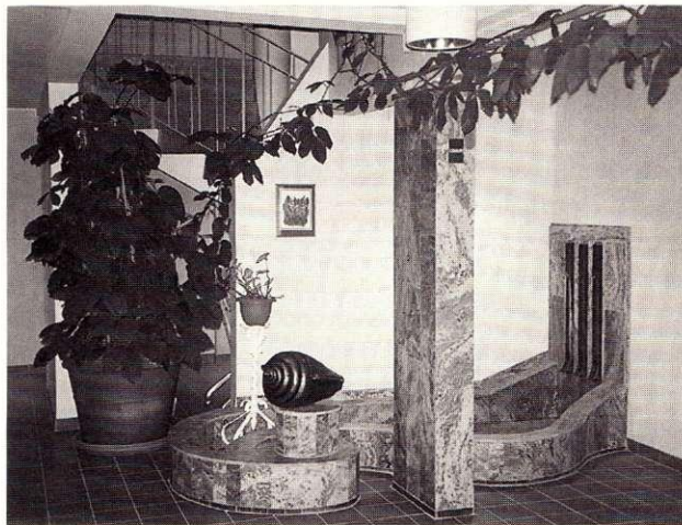
Entréutrymme med vattenspel och växter som fuktar och renar luften. Hyresgästerna kan välja att ta in luften till sin lägenhet via trapphuset eller via ventilerna i yttervägg.
